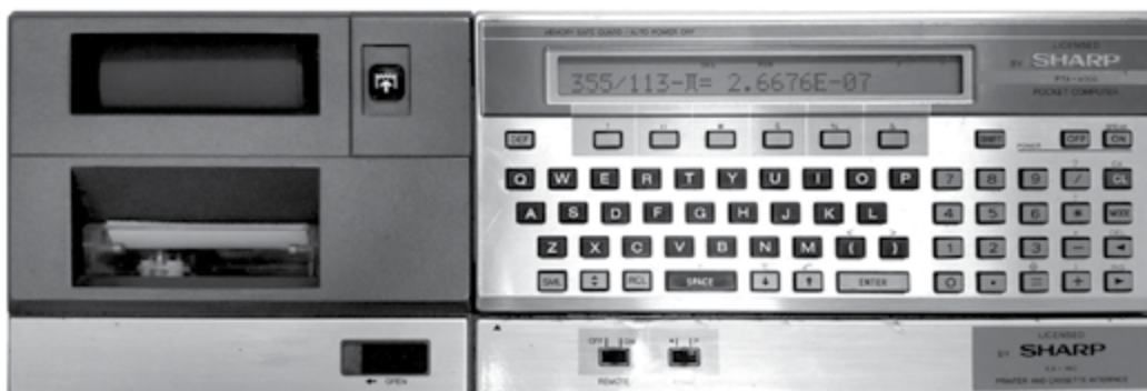
12. ábra: Híradástechnika PTA-4000, az első magyar zsebszámítógép korai változata csatlakoztatott plotterrel
