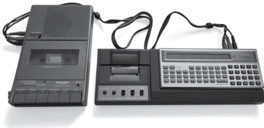
9. ábra: A Sharp PC-1211 a CE-122 nyomtatógységhez és a CE-152 kazettás magnóhoz csatlakoztatva
