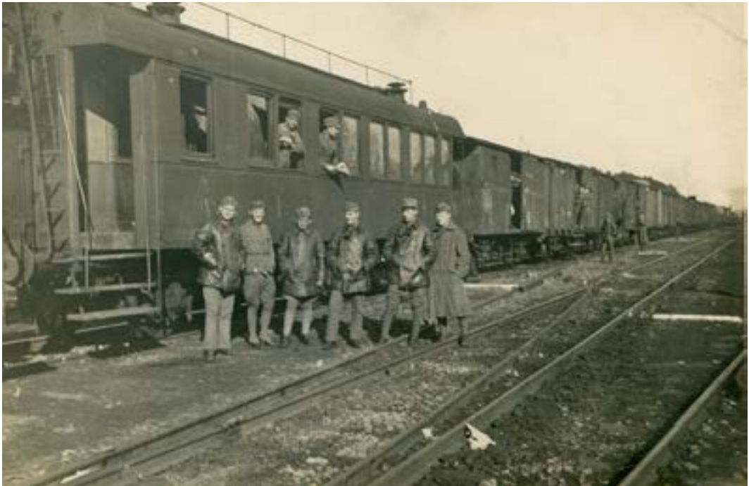
1. kép. Katonavonat, 1918 MMKM TFGY 963: Katonavonat, 1918. A szerelvényben: 1 db Abh 10100 sor. és psz. csoportú háromtengelyes, I/II. oszt. tiszti kocsi, 1 db D 7000 sor. és psz. csoportú kalauzkocsi, és G sor. fedett teherkocsi. Előtérben hat repülő, az első Filipinyi János.
