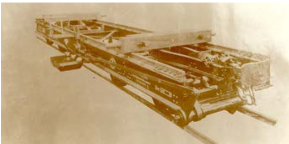
Az Államvasút Társaság (Á.V.T.) resicai bányüzeme a vasúttársaság 1891. évi államosítása után is osztrák kézben maradt annak 948 mm nyomtávolságú iparvasútjával. Győrből 1908-ban 12 olyan különleges kocsi rendeltek, melyekre a normál nyomközű vasúti kocsikat felrakodva, azokat az iparvasúton szénnel megrakhatták, majd a keskeny nyomtávolságú szakaszon a rakott normál nyomtávú járművet a vasúti fővonalig vissza tudták szállítani. A fékező munkahelyéül egészen speciális megoldást találtak. MMKM Archívum, 479-es rendelési szám.
