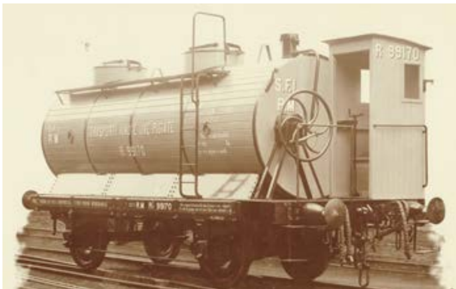
1900-ban a Strade Ferrate del Ferrovia Mediterraneo részére szállított faburkolatú bor- és mustszállító tartálykocsi. MMKM TFGY 1085.
