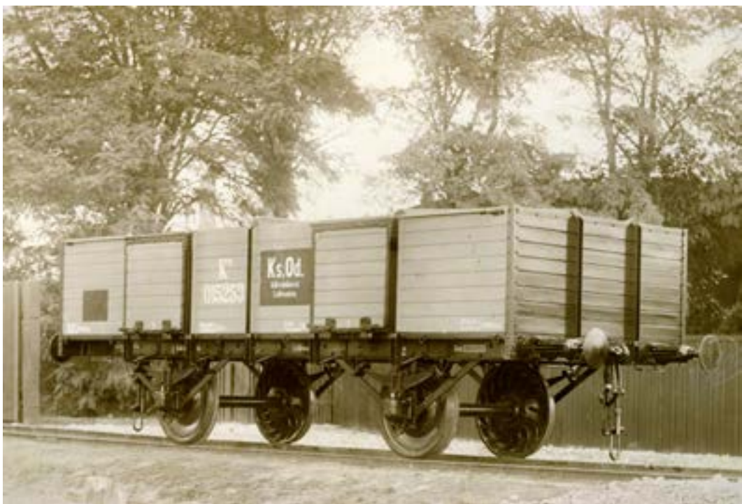
A gyár 2. számú megrendelésére a Magyar Vasúti Forgalmi Rt. részére szállított és a Kassa-Oderbergi vasút részére bérbe adott, K o 015253 pályaszámú magas oldalfalú, 10 tonnás raksúlyú teherkocsi. A kocsi alvázán jól olvasható az első revízió dátuma: 1897. október 28. valamint a „KsOd Kölcsönkocsi – Leihwagen” felirat. MMKM TFGY 1080.
