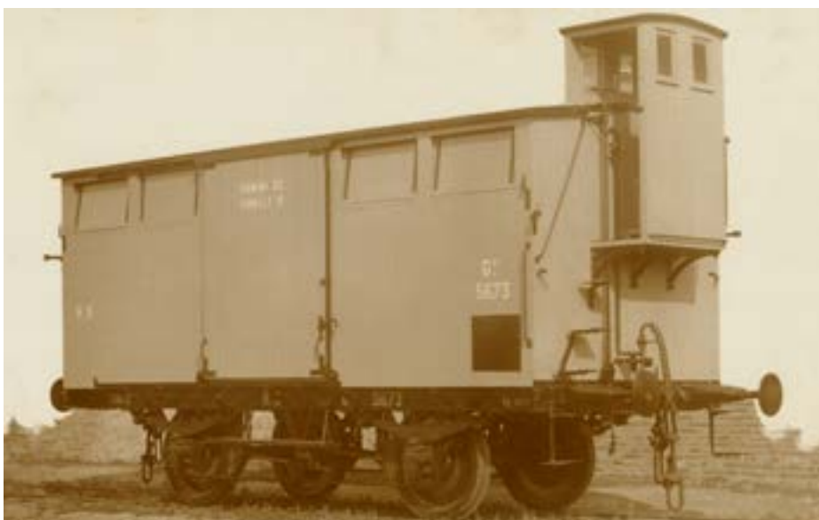
1901-ben a Szicíliai Vasút (Ferrovía del Sicilia) részére szállított fékbódés fedett teherkocsi. MMKM TFGY 1098.
