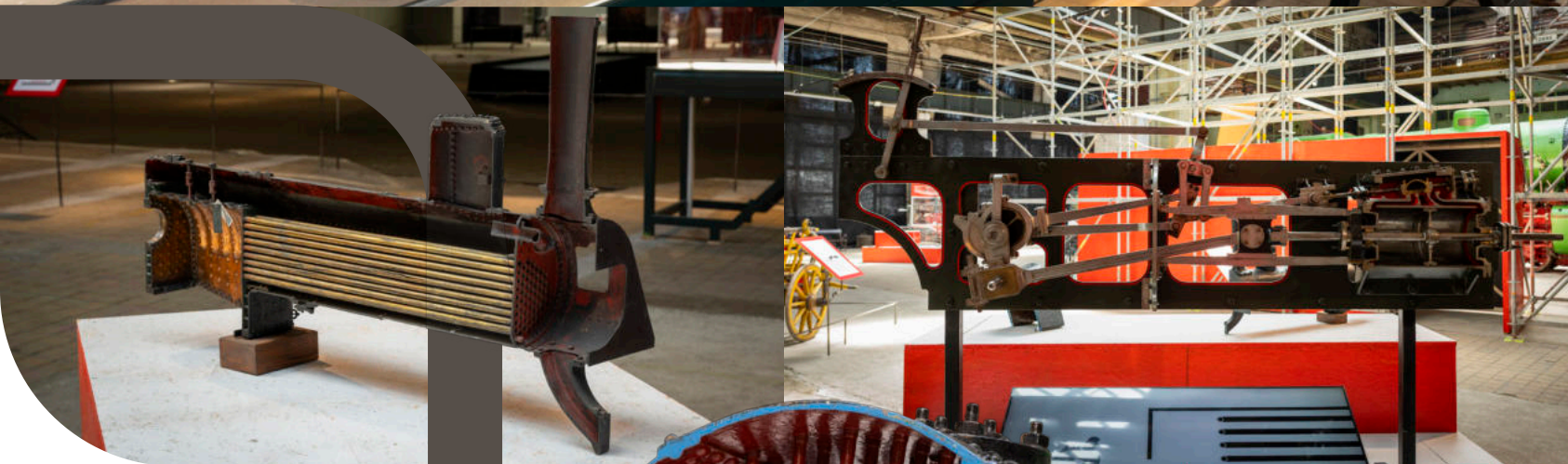
Hullámos mennyezeti tűzszekrényes mozdonykazán hosszmetszeti modellje Longitudinal section of a locomotive boiler 21.71.19.1
