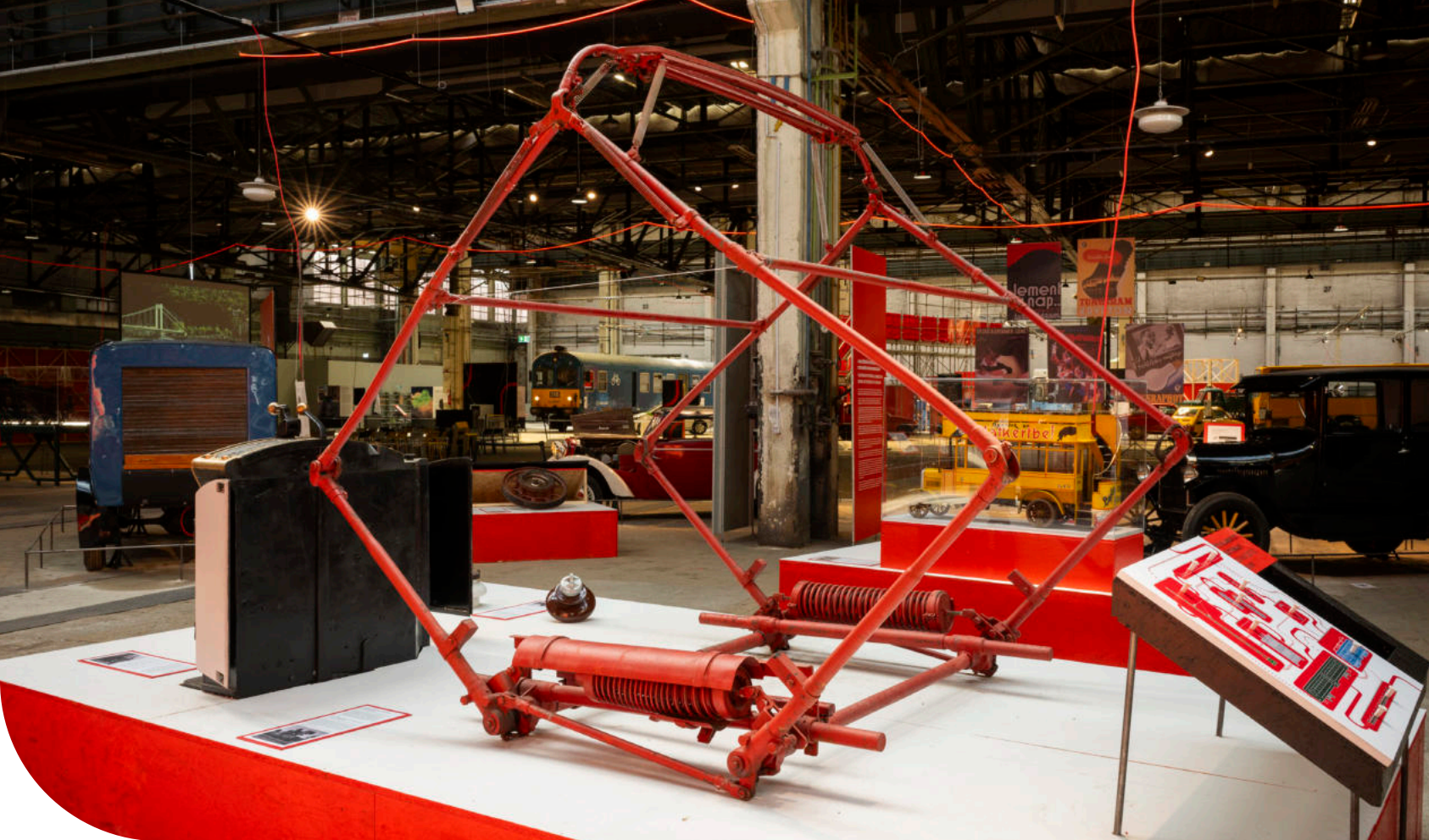
A V42 sorozatú mozdony áramszedője The pantograph of the Class V42 locomotive
