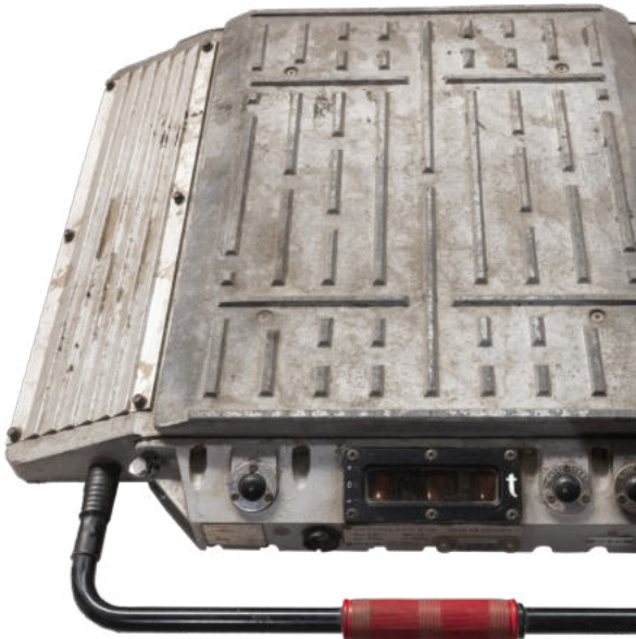
Mérlegrendszer közúti járművek kerékterhelésének méréséhez
