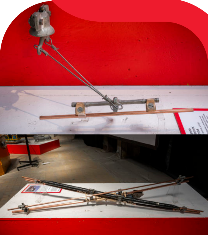
Trolibusz felsővezetékének keresztezése Trolleybus overhead line crossing 30.72.2.1
