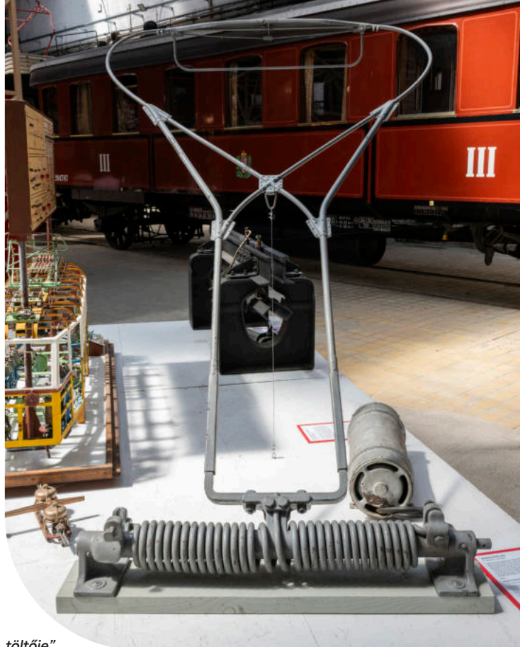
A villamos „töltője” Áramszedő lyra The “charger” of the tram Pantograph “Lyre” 31.72.80
