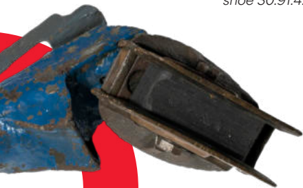
A trolis áramszedőjének papucs The trolleybus pantograph shoe 30.91.4.1.a-c
