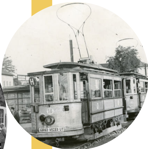
Áramszedő lyra egy nagyvárad-i villamoson. MMKM Archívum Pantograph lyre on a tram in Nagyvárad. MMKM Archives
