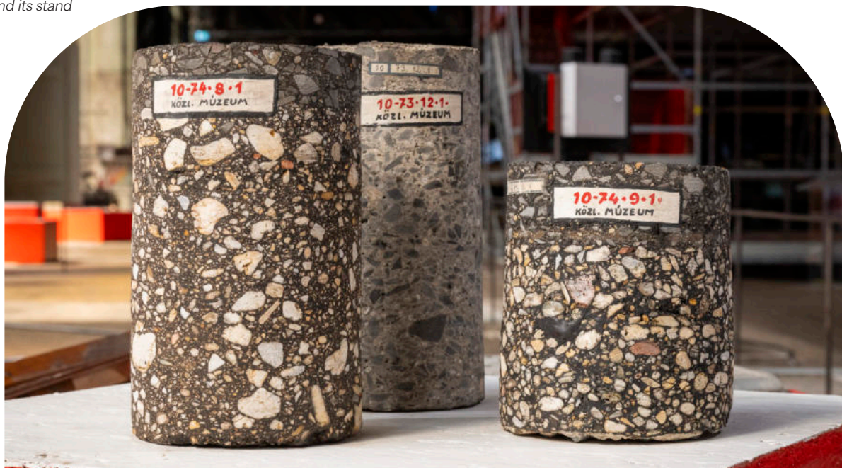
Útminták aszfalt- és betonútból Asphalt road sample 10.74.8.1, 10.74.9.1, 10.73.12.1
