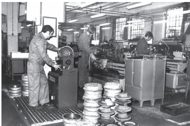
Fékdob eszterga és egytemes esztergagépek a Főtaxi műhelyében
