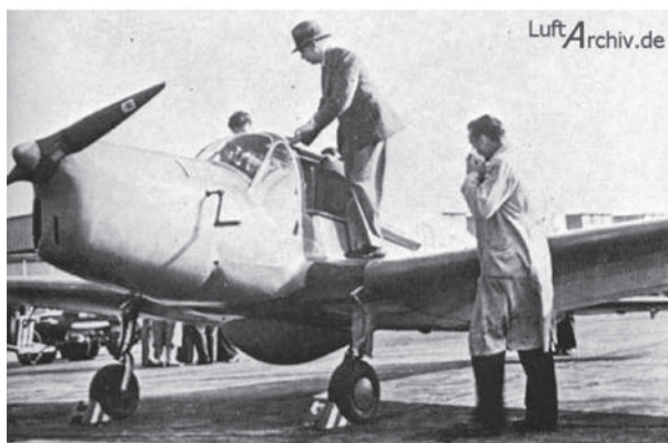
A távolsági rekorder gép fotóján jól látszik a gép hasa alá felszerelt áramvonalas, cséppformájú 120 literes póttartály (LuftArchiv.de)
