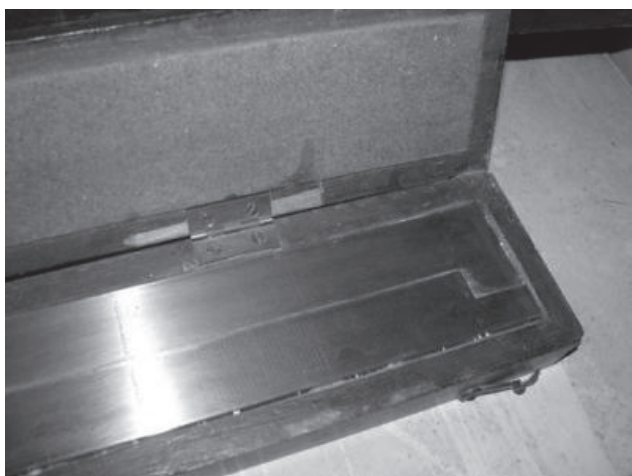
Egy Toise du Pèrouhoz hasonló, egymásba illeszkedő etalonpár végkialakítása
