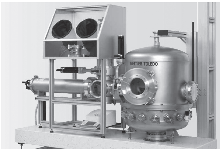
Korszerű vákuumos tömegkomparátor (Mettler Toledo)
