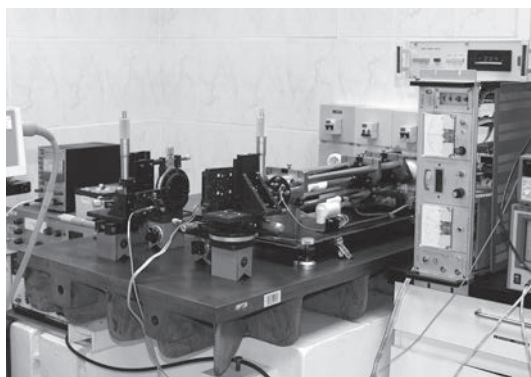
Thomson gyártmányú jódstabilizált He-Ne lézer a külső optikai rendszerrel és az elektronikai egységgel (Az MKEH-ben fotózta a szerző)
