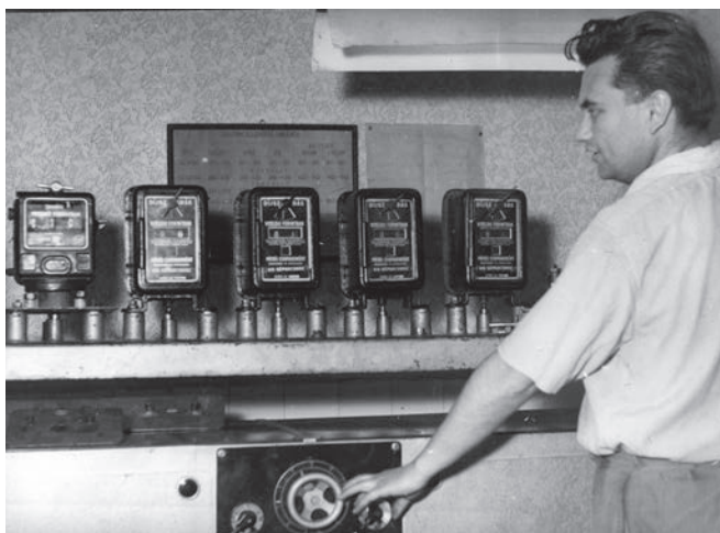
A „régebbi típusú” taxiórák ellenőrző besabályozása az Óra műhelyben
