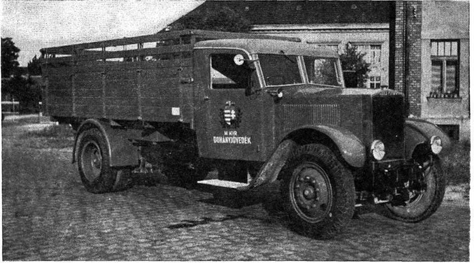
15. ábra. „Rába—Krupp L5N” típusú 5 tonnás gyorstehergépkocsi (1929)
