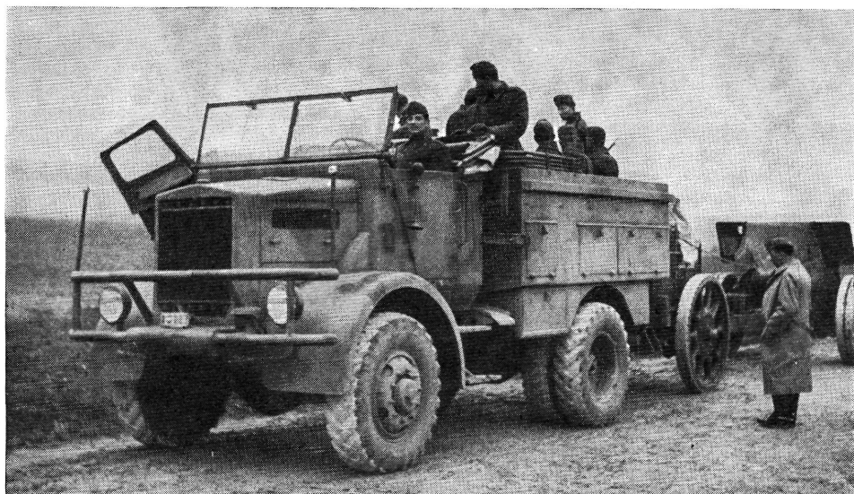
41. ábra. „Rába T 41 M” jellegű négykerék-hajtású tüzérségi vontató (1943)
