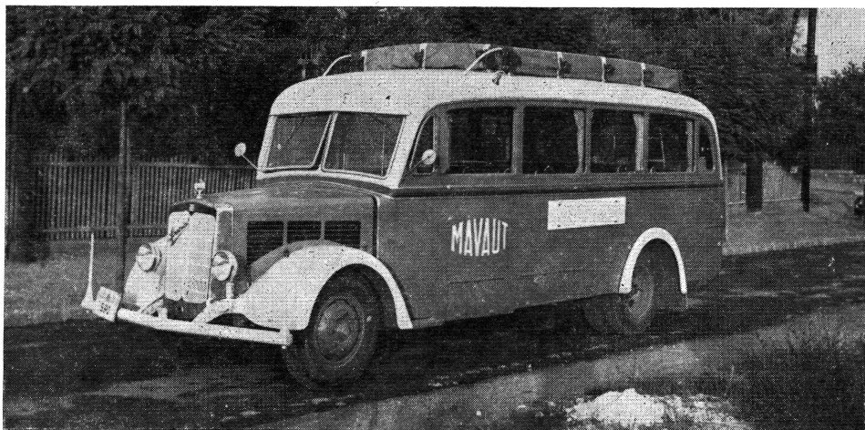
39. ábra. „Rába Speciál” típusú 30 személyes autóbusz, 80 LE-s dízelmotorral (1938)
