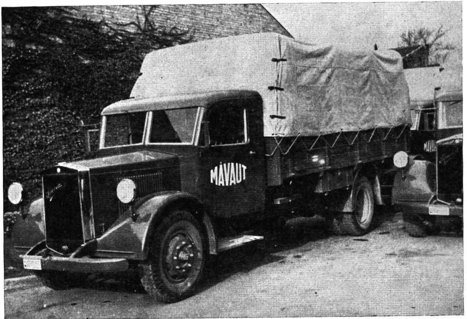
29. ábra. „Rába Speciál” típusú 3,5 tonnás gyorstehergépkocsi (1937)
