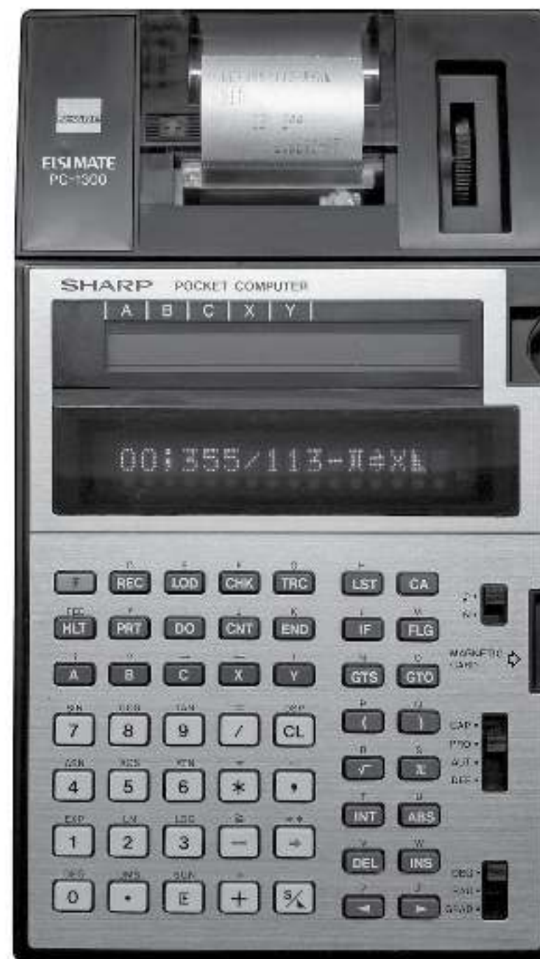
6. ábra: A Sharp PC-1300-as számológépe az egyedülálló pont mátrix VFD kijelzőjével
