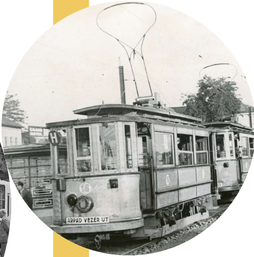
Áramszedő lyra egy nagyváradí villamoson. MMKM Archívum Pantograph lyre on a tram in Nagyvárad. MMKM Archives
