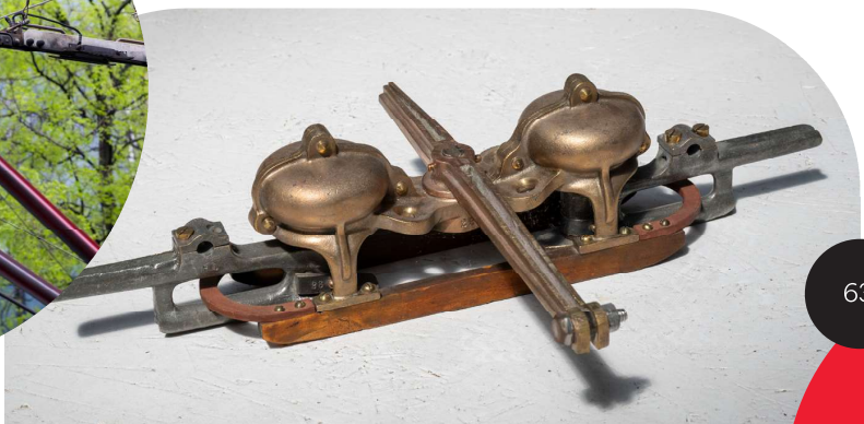
Felsővezetékes szakaszszigetelő a mai Budapesten MMKM Archívum Overhead wires with section insulator in today's Budapest MMKM Archives
