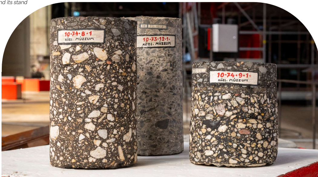
Útminták aszfalt- és betonútból Asphalt road sample 10.74.8.1, 10.74.9.1, 10.73.12.1
